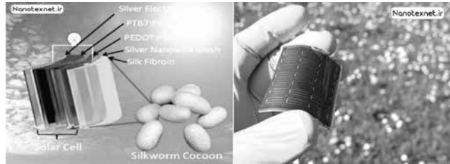
تصویر شماره ۴- تصویری از پیله کرم ابریشم و سلول‌های خورشیدی زیست‌سازگار پلاستیکی از فیبروئین ابریشم که می‌تواند منعطف و سازگار با پوست انسان باشد.
